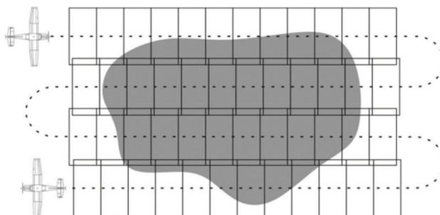
El resultado de este vuelo es el conocido como "fotograma aéreo", que para los vuelos digitales se captura en sus bandas rojo, verde, azul e infrarrojo, y que tiene una proyección cónica con deformaciones angulares.
