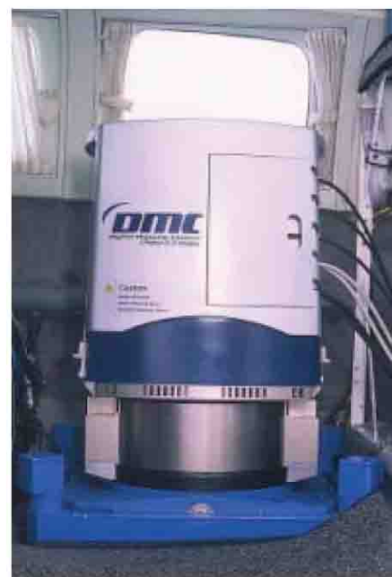
Cámara Digital (DMC de Intergraph)
