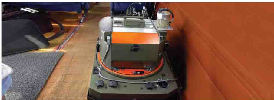
Cámara analógica (RC-30 de Leica)
